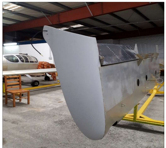
Pose des saumons d'ailes et ailerons/volets
