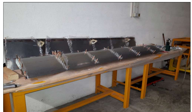
Montage des ailerons et volets. On voit les Clecos qui servent au pré-assemblage
