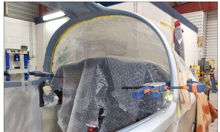
Pose de la casquette et du pare-brise (un autre morceau de bravoure)
